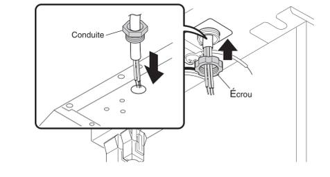
4 Connectez les fils électriques de la manière suivante : Serrez les fils bien fermement en utilisant des connecteurs de fils (non fournis).
