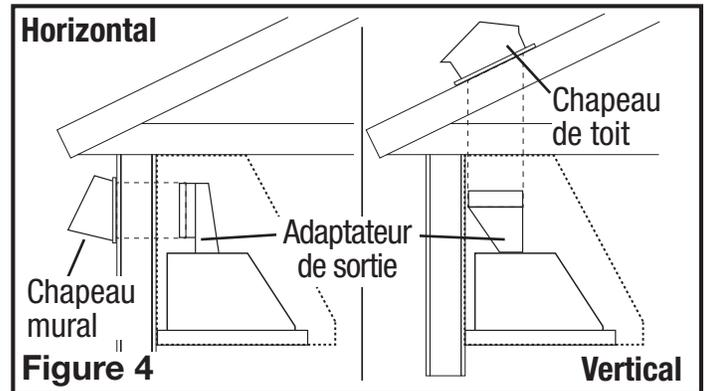
**REMARQUE :** Pour des modèles utilisant le ventilateur B300, B500 ou B600, un conduit et un adaptateur de sortie de 6 po de diamètre au minimum sont exigés pour obtenir la circulation d'air appropriée. Le B900 exige un conduit et un adaptateur de sortie de 8 po de diamètre au minimum. Le B1125 exige un conduit et un adaptateur de sortie de 10 po de diamètre au minimum.
