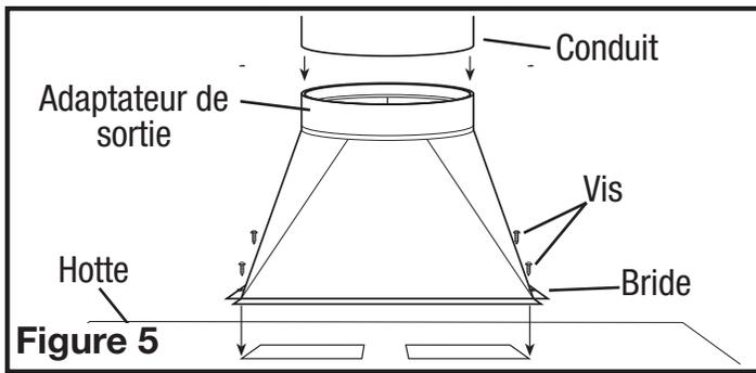
3. Quand il y a accès au dessus de l'unité, reliez la canalisation au collier de conduit et fixez-la en place en utilisant un ruban adhésif pour sceller tous les joints (Figure 5).
