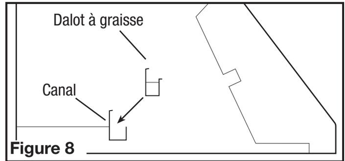
3. Installez les filtres à chicanes et toutes les entretoises inclus avec l'unité en insérant le dessus du filtre dans le canal supérieur du capot, puis faites glisser le bas du filtre dans le canal inférieur. Les filtres comprennent un dessus et un dessous. Le dessous du filtre aura des trous de vidange de petite taille. Ces trous doivent être orientés vers le bas vers le collecteur de graisse pour être efficace (Figure 9).
