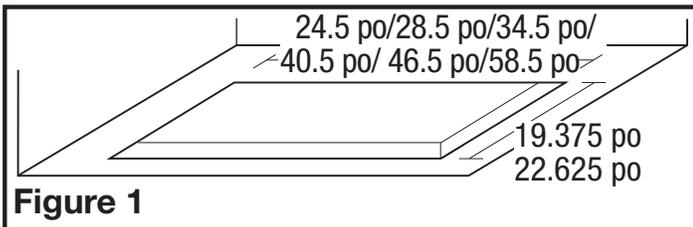
**REMARQUE :** La hotte doit être montée à un minimum de 24 po et à un maximum de 36 po de la surface de cuisson.
