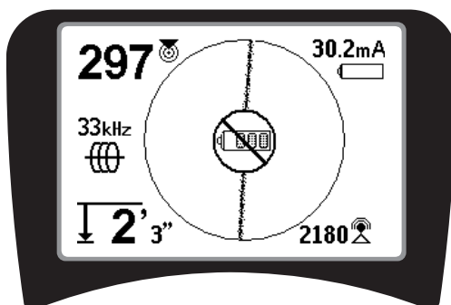
Figure 10 – Témoin de piles déchargées
