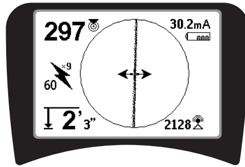
Figure 25 – Fréquence de traçage passif de 60 (9ième) Hz
