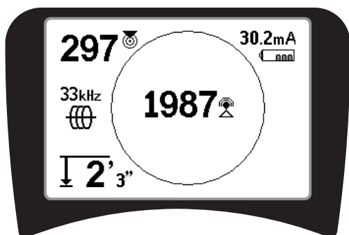
Figura 40 - Intensidad de la señal aparece centrada en la pantalla
