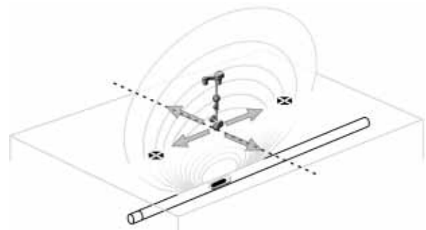
Figure 28 – Pôles et équateur d'une sonde
