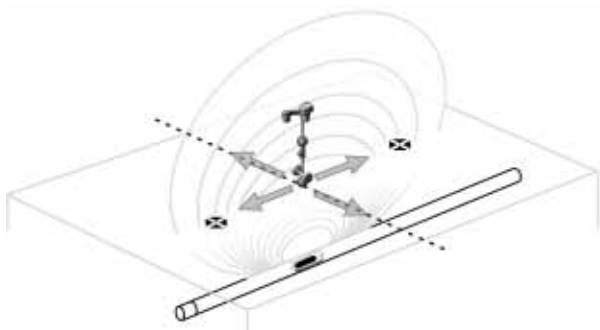
Figura 28 - Polos y Ecuador de una Sonda
