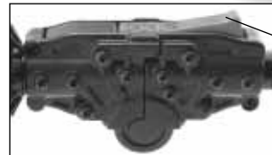
Figure 5 – Mât d'antenne pliant et bouton d'ouverture
