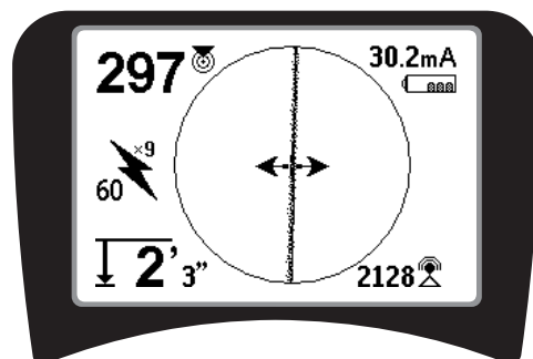
Figura 25 – Frecuencia de rastreo pasivo de 60 hz (novena)
