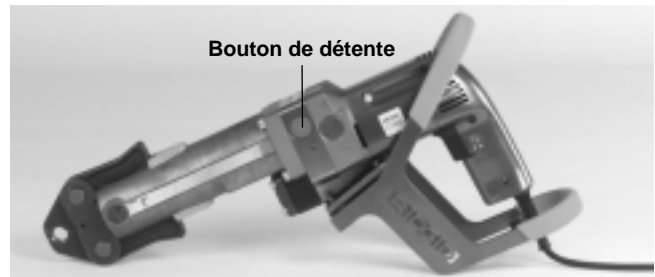
Figure 7 – Utilisation du bouton de détente (si nécessaire)
