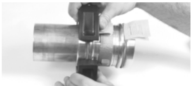
Figura 8 – Instalación del aro sobre el acoplamiento
