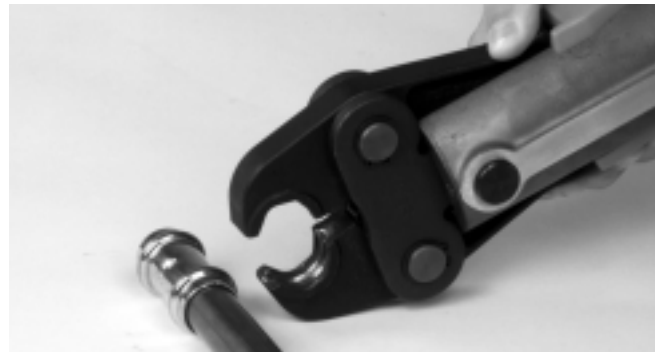
Figura 4 – Apertura de las mordazas tipo tijeras
