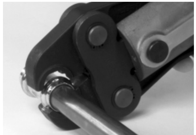
Figura 5 – Montaje de las mordazas alrededor del acoplamiento
