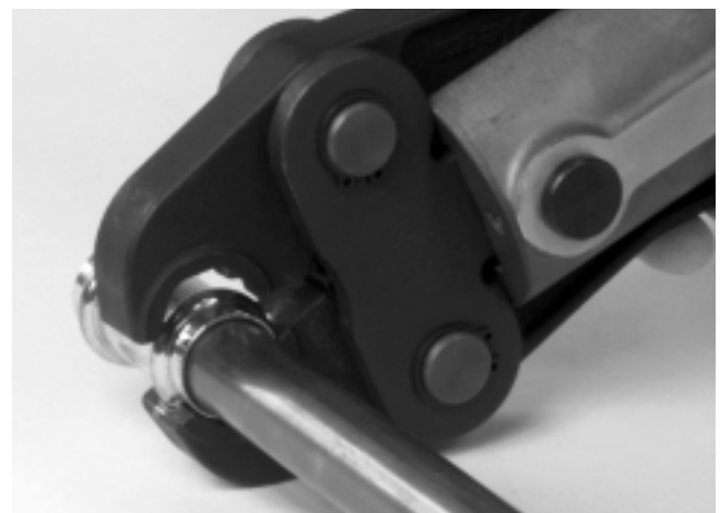
Figure 5 – Positionnement du jeu de mâchoires à ciseaux sur le raccord
