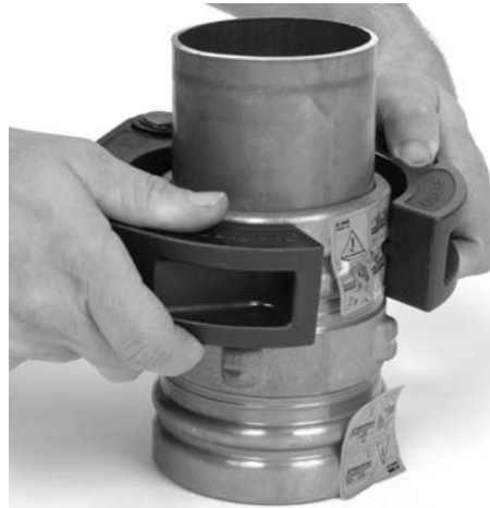
Figure 9 – Positionnement de la bague de sertissage sur le raccord
