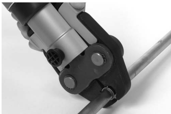
Figura 7 – Mordazas tipo tijeras rodeando el acoplamiento
