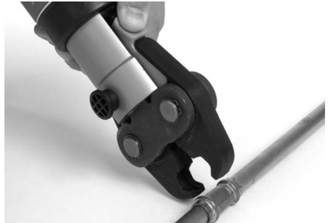
Figure 6 – Ouverture des mâchoires à ciseaux
