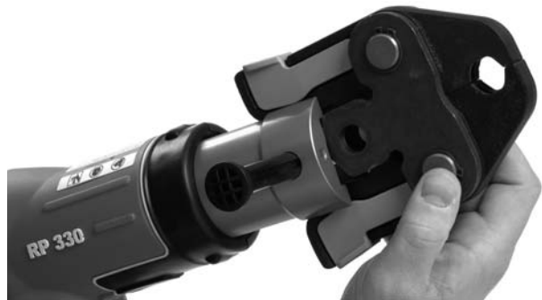
Figure 5 – Introduction de l'accessoire dans l'appareil
