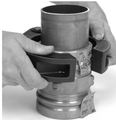
Figura 9 – Montaje del aro sellador sobre el acoplamiento
