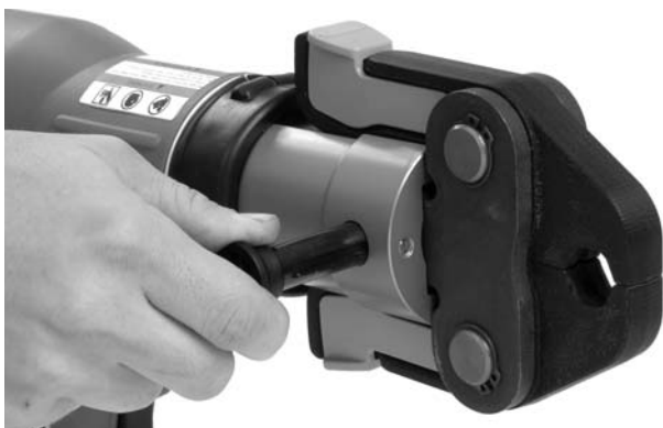
Figure 4 – Broche de fixation des accessoires en position complètement ouverte
