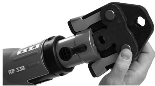
Figura 5 – Coloque el accesorio (mordazas) en la nariz de la Selladora
