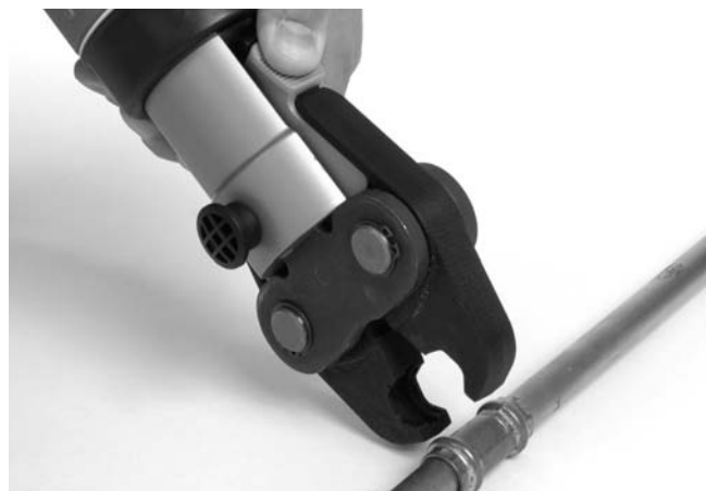
Figura 6 – Apertura de las mordazas tipo tijeras
