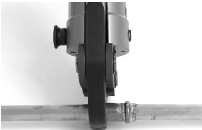
Figure 8 – Sertisseuse RP 330 d'équerre avec le tuyau
