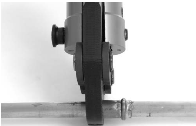
Figura 8 – Mordazas y Selladora RP 330 en ángulo recto con respecto al tubo
