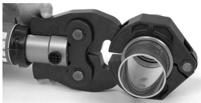
Figura 10 – Montaje del accionador al aro sellador
