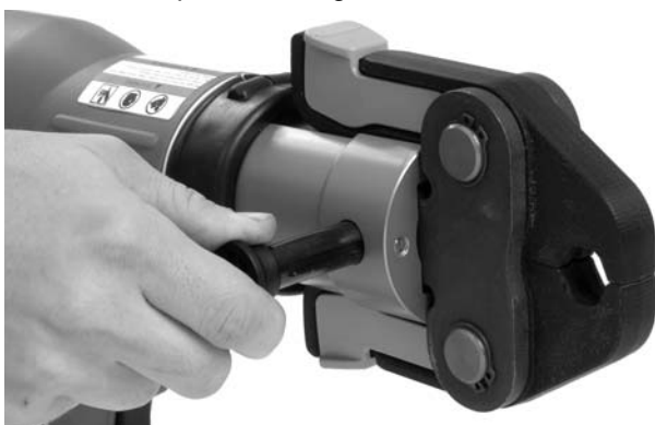
Figura 4 – Retire hasta atrás el pasador para el montaje del accesorio (mordazas)
