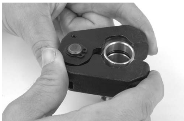
Figura 9 – Montaje del aro sellador sobre el acoplamiento
