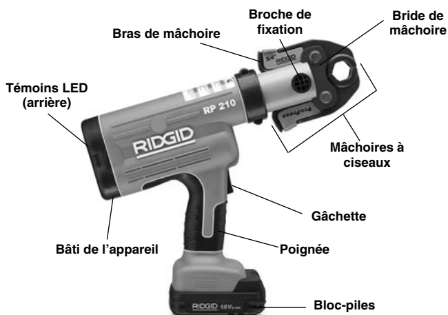
Figure 1 – Sertisseuse RP 210 avec mâchoires série Compact
