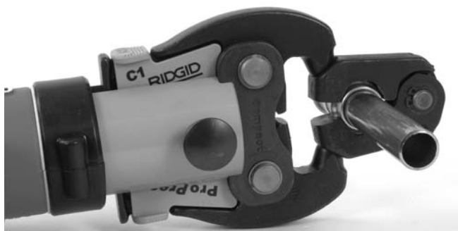
Figura 10 – Montaje del accionador en el aro sellador
