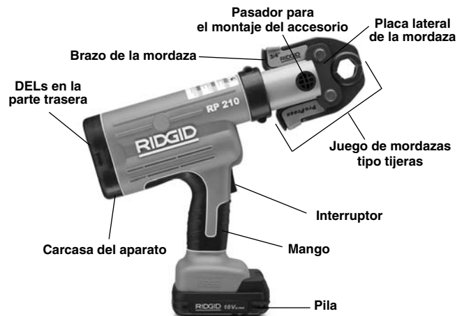
Figura 1 – Selladora RP 210-B (a pila) y juego de mordazas serie Compact
