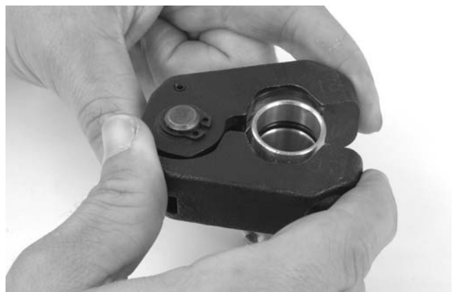
Figure 9 – Positionnement de la bague de sertissage sur le raccord
