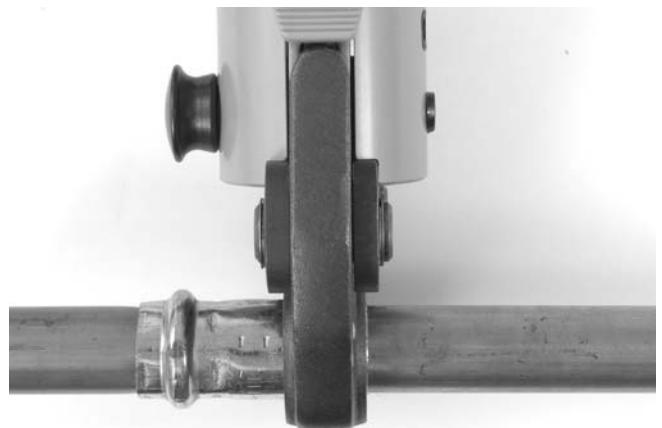
Figure 8 – Sertisseuse RP 210 d'équerre avec le tuyau
