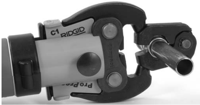
Figure 10 – Positionnement de l'actionneur sur la bague de sertissage
