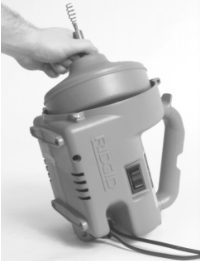
Figura 11 – Montaje del tambor a la máquina
