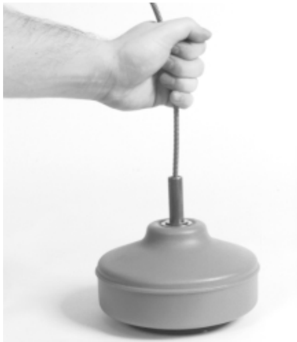
Figure 10 – Rembobinage du câble dans le tambour
