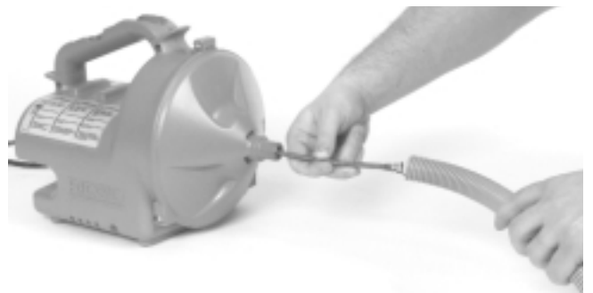
Figure 2 – Enfilage du câble dans le guide-câble
