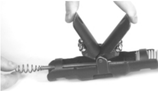
Figura 3 – Modo de hacer pasar el cable por la AUTOFEED™
