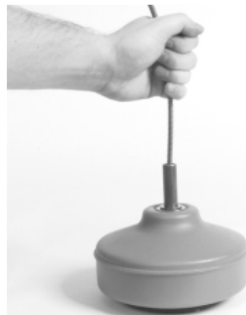
Figura 10 – Introducción del cable en el tambor
