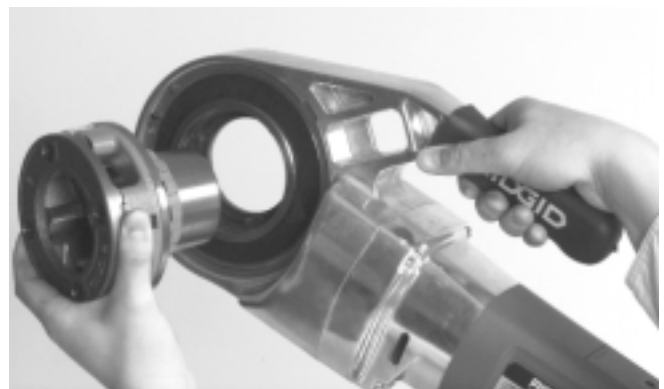
Figure 3 – Installation des têtes de filière type 11-R
