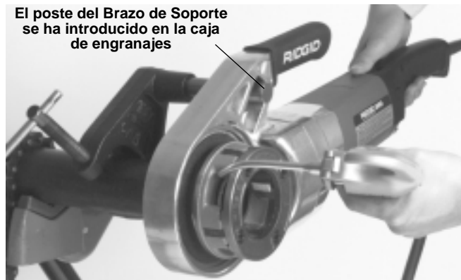
Figura 7 – Aplicación de aceite mientras se rosca
