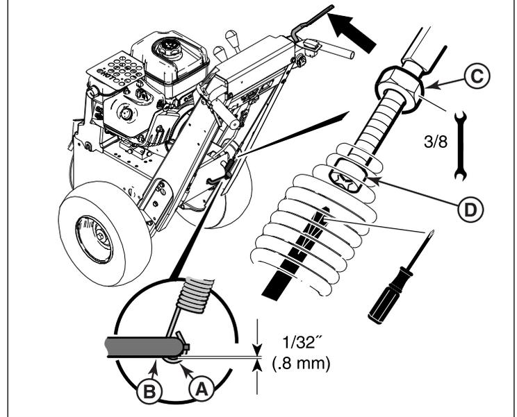
2. Pour ajuster, desserrer l'écrou (C) en tenant la vis d'ajustement (D) et en tournant l'écrou. Puis faire tourner le tendeur et tenir la vis de réglage (D). La vis de réglage est une vis Phillips et la tête peut être maintenue ou tournée en insérant un tournevis à travers le ressort.
