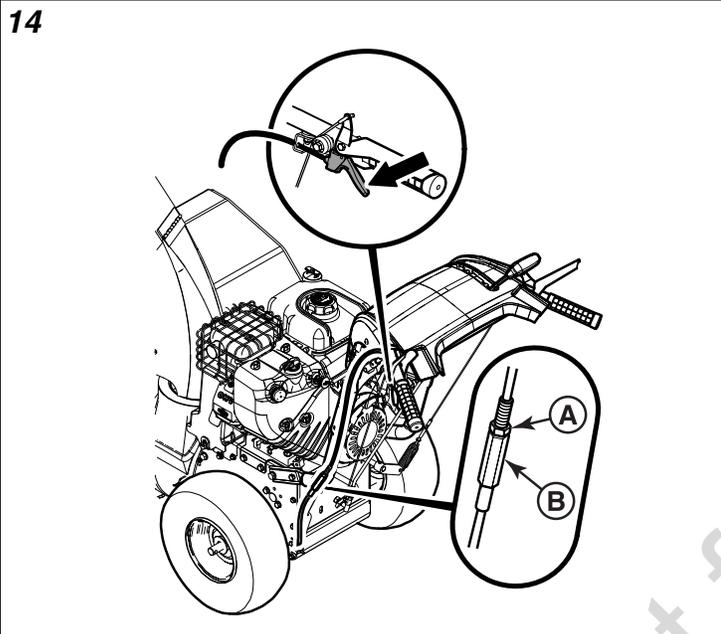
3. Tourner l'écrou de réglage (B) pour allonger ou raccourcir le câble. Le câble doit être resserré jusqu'à ce qu'il n'y ait plus de jeu dans le levier. Cependant, il ne doit pas embrayer la commande Easy-Turn si on n'appuie pas sur le levier de commande.
