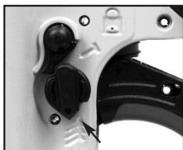
Modo de disparo de contacto (interruptor selector del modo de disparo apuntando hacia abajo)
