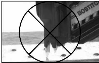
Mauvais placement du clou
