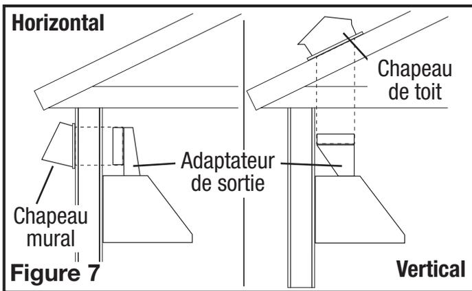
**REMARQUE :** Pour des modèles utilisant les ventilateurs B300, B500, ou B600, un conduit et un adaptateur de sortie de 6 po de diamètre au minimum sont exigés pour obtenir la circulation d'air appropriée. Le B900 exige un conduit et un adaptateur de sortie de 8 po de diamètre au minimum, alors que le B1125 exige un conduit et un adaptateur de sortie de 6 po de diamètre au minimum.
