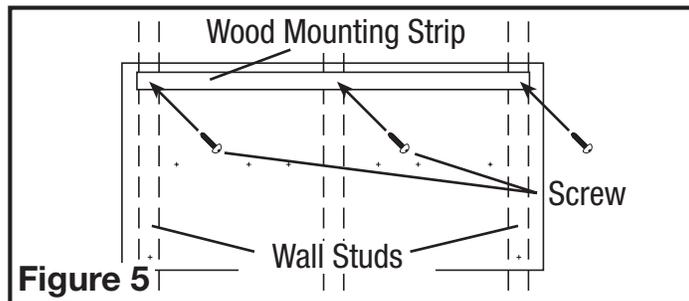
**CAUTION:** DUE TO THE WEIGHT OF THE HOOD, ENSURE THE WOOD STRIP IS FASTENED TO ALL AVAILABLE WALL STUDS (A MINIMUM OF 2 STUDS FOR 30" HOODS, MORE AS THE WIDTH INCREASES) NOT INTO THE DRYWALL ALONE.
