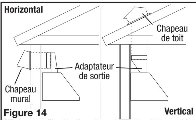
**REMARQUE :** Pour des modèles utilisant les ventilateurs B300, B300, ou B600, un conduit et un adaptateur de sortie de 6 po de diamètre au minimum sont exigés pour obtenir la circulation d'air appropriée. Le B900 exige un conduit et un adaptateur de sortie de 8 po de diamètre au minimum, alors que le B1125 exige un conduit et un adaptateur de sortie de 6 po de diamètre au minimum.
