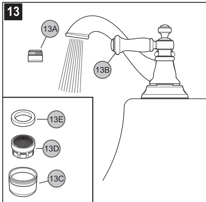
**13 RINÇAGE ET NETTOYAGE DE L'AÉRATEUR**
