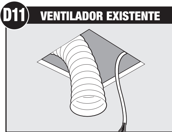
Retire el ventilador existente y asegúrese que la abertura sea suficientemente grande para acomodar el alojamiento del motor nuevo (9" x 9.75").
