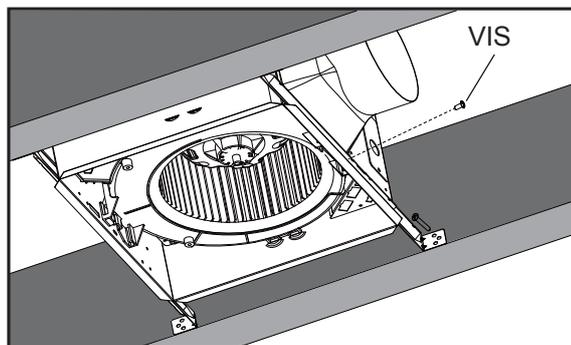
Fixez les barres de suspension à la charpente à l'aide d'une vis à chaque extrémité de la barre de suspension. Sélectionnez un trou approprié et fixez les barres de suspension ensemble à l'aide des vis à bride.
