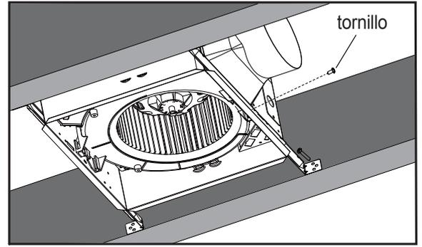
3. **INSTALE EL CONDUCTO REDONDO** Conecte el conducto redondo (no incluido) al conector de la compuerta/conducto y lleve el conducto hasta la cubierta de techo o pared (no incluida). Usando cinta (no incluida), asegure todas las conexiones de los conductos para que sean herméticas.
