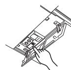
Cada vez que se pulsa el interruptor de accionamiento de emergencia (E.O. SW), el funcionamiento cambia en el orden siguiente:
