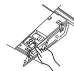
Cada vez que se pulsa el interruptor de accionamiento de emergencia (E.O. SW), el funcionamiento cambia en el orden siguiente:
