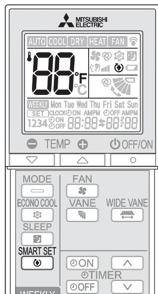
**1** Appuyez sur en mode REFROIDISSEMENT ou CHAUFFAGE page 5 pour sélectionner le mode SMART SET (REGLAGE INTELLIGENT).
