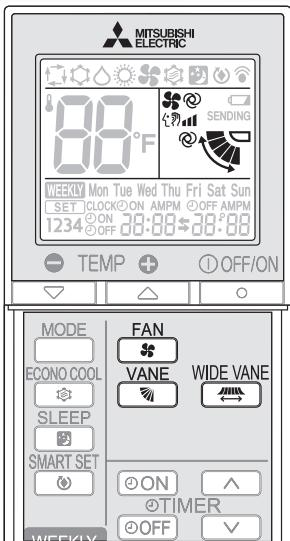
Pulse **FAN** para seleccionar la velocidad del ventilador. La velocidad del ventilador cambia con cada pulsación en el orden siguiente:
