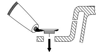
3. Introduzca hacia arriba el extremo roscado del cuerpo del desagüe por el orificio de desagüe y conecte el reborde al cuerpo.
