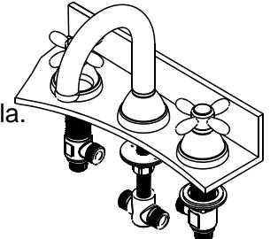
5. Conecte los dos tubos flexibles al adaptador de la boca. Asegúrese de que el tubo derecho de conecte con el lado izquierdo del adaptador de la boca y que el tubo izquierdo se conecte con el lado derecho del adaptador de la boca.
