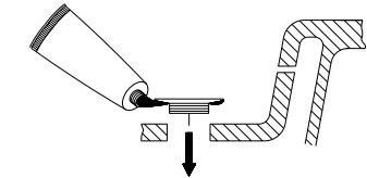
3. Insérez la tête filetée du corps de drain dans le trou d` évacuation et attachez la tige.
