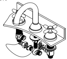
6. Appliquez le ruban adhésif sur l'adaptateur du corps de robinet avant de joindre le tuyau d'alimentation d'eau.
