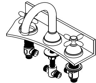
5. Joignez les deux boyaux flexibles à l'adaptateur du bec. Rassurez -vous que le boyau provenant du robinet droit est rattaché au côté gauche de l'adaptateur de bec. Aussi, le boyau provenant du robinet gauche est rattaché au côté droit de l'adaptateur de bec.
