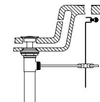
5. insérez le bout de la tige d`ascenseur dans le trou au dessus de l`armature de la tige de pivot. Serrez avec une vis de pouce.
