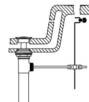
5. Introduzca la parte inferior de la palanca en el orificio de la parte superior de la tira de la palanca. Apriete con el tornillo manual.
