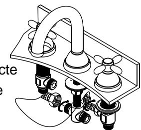
6. Aplique cinta adhesiva para tubos en las roscas del adaptador del cuerpo de la válvula antes de conectar el tubo de suministro de agua.
